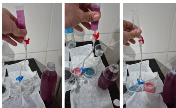
Figura 4. Teste de acidez com vinagre e bicarbonato de sódio utilizando o protótipo e extrato de repolho roxo como indicador.
