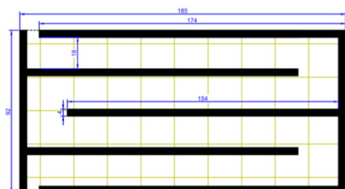
Figura 1. Modelo bidimensional do reator com suas principais dimensões.
