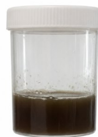
Figura 7. Aspecto visual da mistura de extrato de Citrus sinensis com sal de zinco após 35 dias, evidenciando a formação de precipitado.
