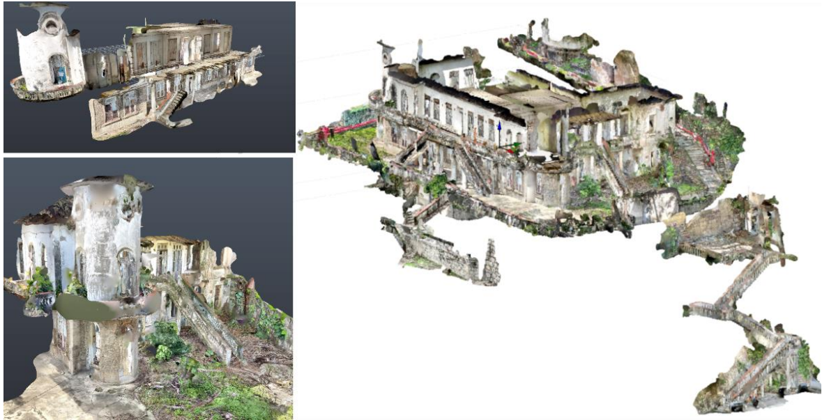
Figura 5 – Nuvem de pontos no Recap e Integração do modelo no Revit - Palacete da Condessa Pereira Carneiro. Fonte: dos autores.
