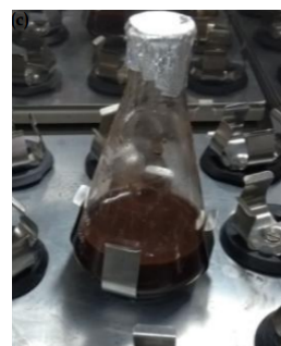
Figura 3. Incorporação da lignina por metodologia ex situ agitada (Souza, 2021).
