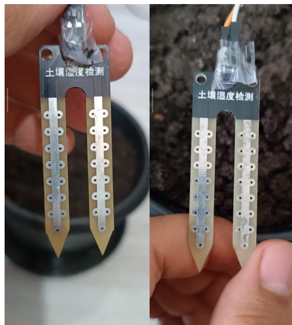
Figura 11. Eletrodos dos sensores CO e CA após primeiro dia de experimento.
