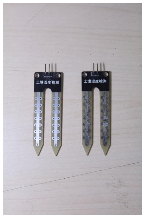
Figura 12. Comparação visual dos eletrodos dos sensores CO e CA após sete dias de experimento.
