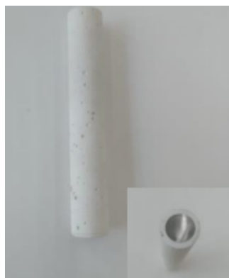
Figura 2. Eletrodo de disco rotatório (Assunção, 2023).
