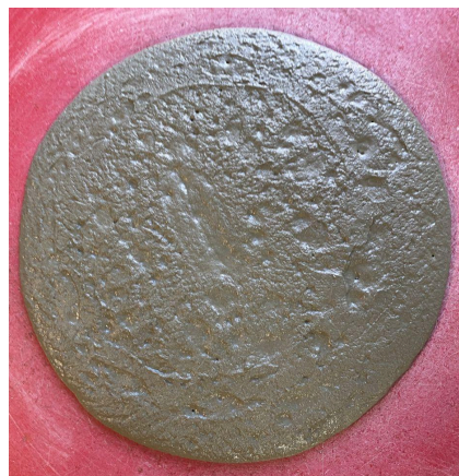
Figura 6. Determinação do espalhamento argamassa FD10.
