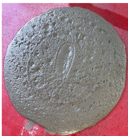
Figura 7. Determinação do espalhamento argamassa FD20.
