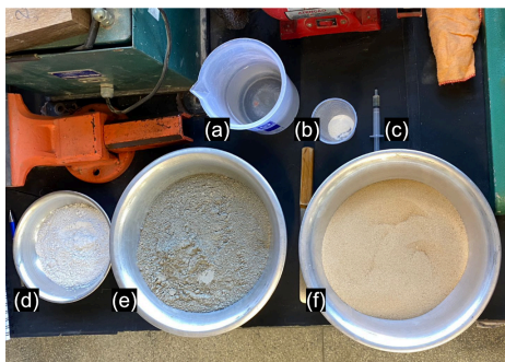
Figura 3. Materiais utilizados: (a) água, (b) VMA, (c) SP, (d) filler dolomítico, (e) CP II-Z 40 e (f) areia fina.
