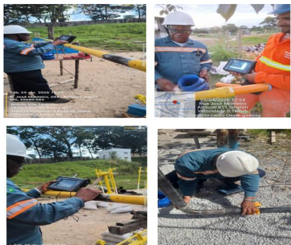
Figura 4: Inspeção ultrassônica em tubulação exposta
