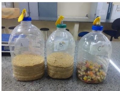
Figura 01: teste de biogás em diferentes substratos
