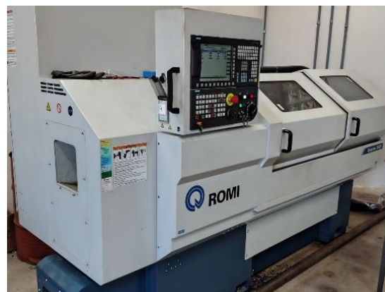
Figura 2. Torno CNC utilizado nos testes de usinagem.
