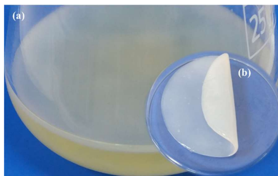
Figura 1. Produção e purificação do hidrogel de NCB. (a) Película de NCB recém-sintetizada após o cultivo estático em meio de cultura, apresentando coloração amarelada devido à presença de resíduos metabólicos e componentes do meio. (b) Hidrogel de NCB após o processo de purificação, exibindo aspecto translúcido e homogêneo em decorrência da remoção de células bacterianas e impurezas.
