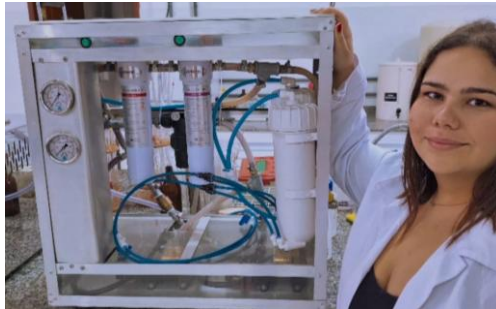
Figura 1 – Sistema piloto de dessalinização por osmose reversa utilizado nos ensaios experimentais.
