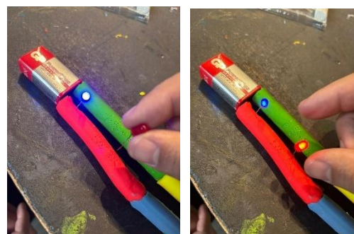
Figura 3. Circuito em paralelo construído com massinha de modelar, evidenciando a diferença de luminosidade entre os LEDs em função das diferentes resistências nos ramos do circuito.
