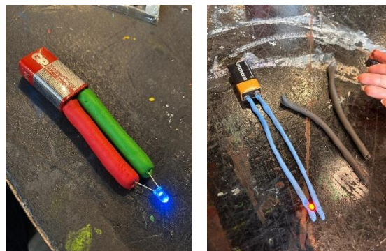
Figura 1. Comparação entre circuitos construídos com massinha de modelar: (esquerda) circuito com rolinhos de maior espessura; (direita) circuito com rolinhos mais finos. A redução da luminosidade do
