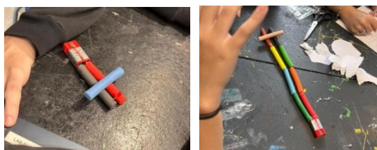
Figura 2. Configurações de curto-circuito exploradas com massinha de modelar: (esquerda) curto-circuito realizado antes do LED, resultando no apagamento do componente; (direita) curto-circuito após o LED, no qual a luminosidade é mantida em função da maior resistência do caminho alternativo.
