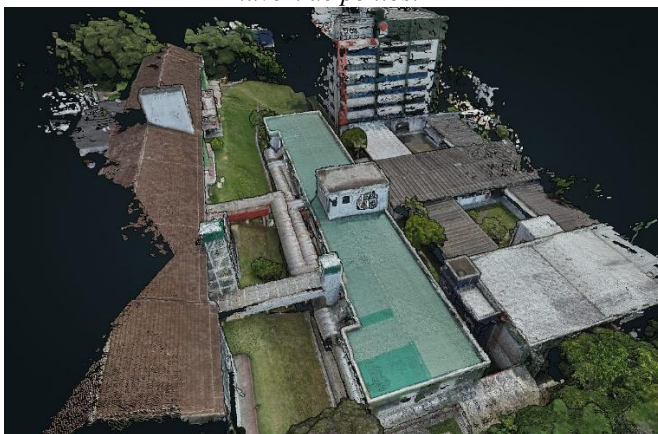
Fig. 3 - Vista 1 do modelo do Bloco K gerado a partir da nuvem de pontos.
