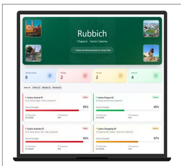
Fig. 1. Representação da interface do Sistema Rubbich de monitoramento inteligente de resíduos em tempo real para a cidade de Chapecó SC, exibindo o dashboard de controle e o status das lixeiras conectadas.
