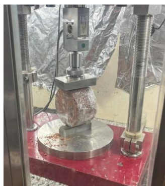
Figura 4. Corpo de prova submetido ao ensaio de compressão diametral em prensa universal.
