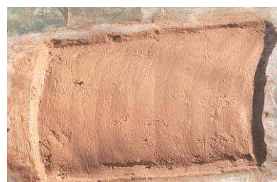
Figura 4. Telha 1.1, com proporção de 70% á 30%.
