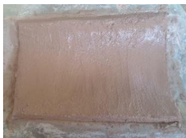
Figura 5. Telha 2, com proporção de 50% de solo argiloso e 50% de cinza de algaroba.
