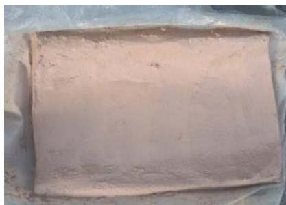
Figura 5. Telha 2, com proporção de 50% de solo argiloso e 50% de cinza de algaroba.
