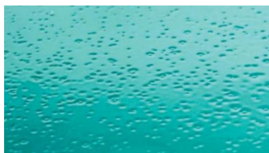
Figura 4. Efeitos visuais de crateras (olhos de peixe) em uma superfície pintada. Fonte: PPG (2026).
