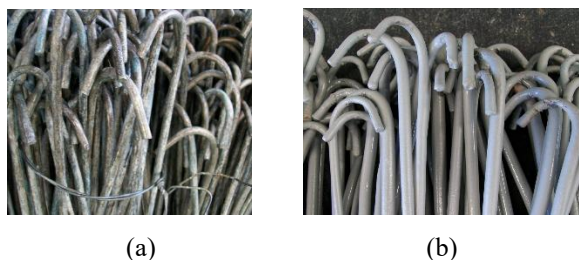
Figura 3. Gancheiras encrustadas com camadas de tinta seca (a) e gancheiras desencapadas e adequadas para uso (b). Fonte: AB5 (2023).
