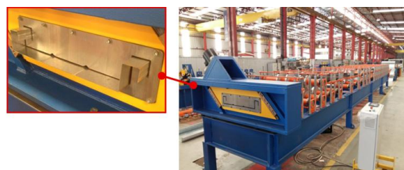
Figura 6. Perfilação dos módulos de aço galvanizado (Fonte: Adaptado Quick House , 2025)
