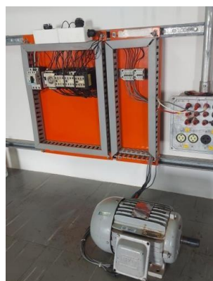
Figura 7. Motor no fechamento estrela-triângulo.
