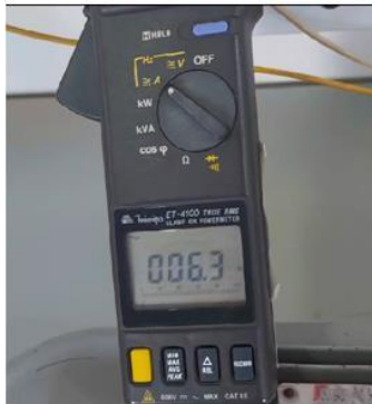
Figura 10. Corrente encontrada na partida soft starter.
