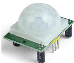
Figura 2. Sensor de presença HC-SR501 PIR.
