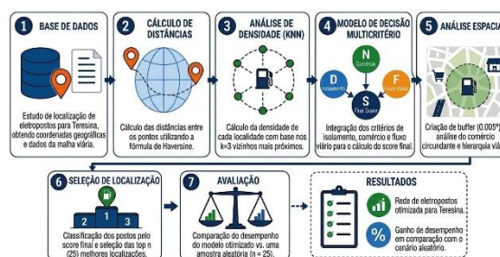
Figura 1: Fluxo metodológico para a seleção de locais otimizados para a instalação de eletropostos em Teresina.
