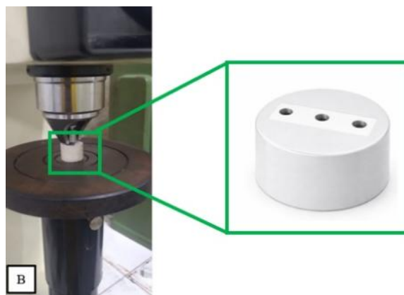
Figura 4. Realização da dureza vickers no durômetro do modelo Pan Tec hrn 150
