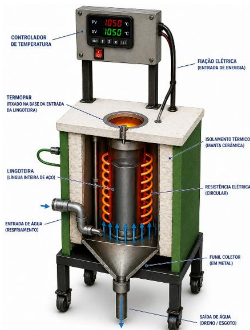
Figura 2 - Esquema ilustrativo do Forno de solidificação unidirecional ascendente
