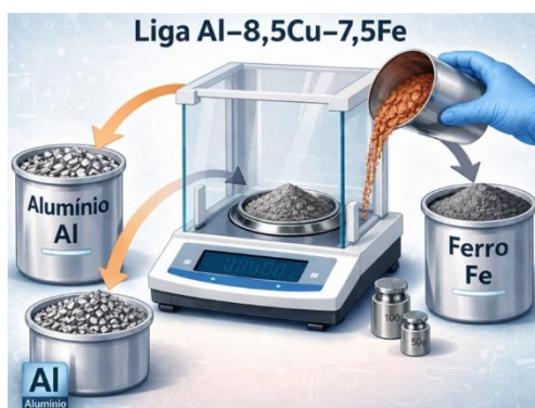
Figura 1. Pesagem dos elementos químicos (Al, Cu, Fe) para confecção da liga
