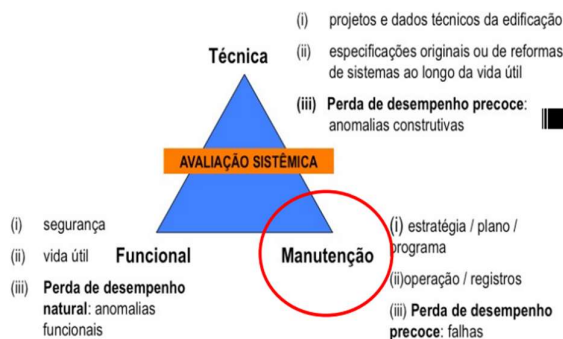
Figura 9. Aspectos Básicos da Inspeção Predial.
