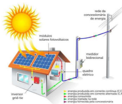
Figura 2. Funcionamento da energia solar fotovoltaica.
