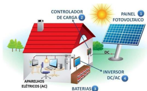
Figura 4. Sistema fotovoltaico isolados à rede (off-grid).
