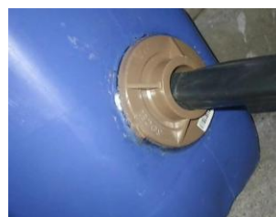
Figura 3. Sistema de agitação manual do biodigestor.
