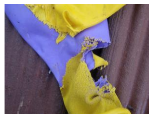
Figura 1. Degradação dos balões utilizados no armazenamento do biogás.
