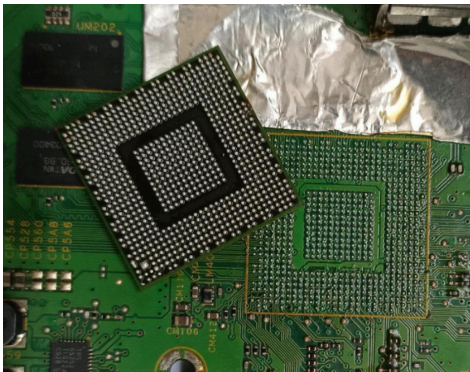
Figura 3. Chip BGA removido. Fonte: elaboração própria.
