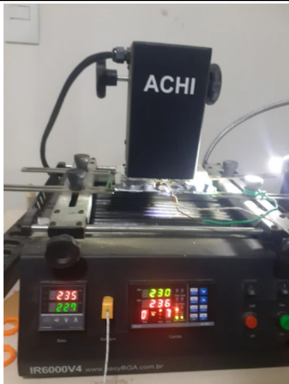
Figura 2. Estação de retrabalho BGA configurada com o perfil desenvolvido. Fonte: elaboração própria.
