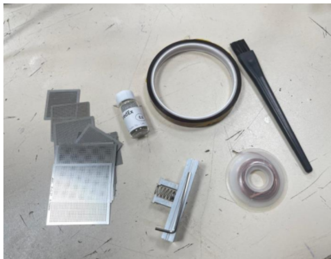
Figura 1. Malha dessoldadora; Fita de proteção térmica; Stencil BGA; Pinça de precisão; Pincel; Dispositivo de fixação.
