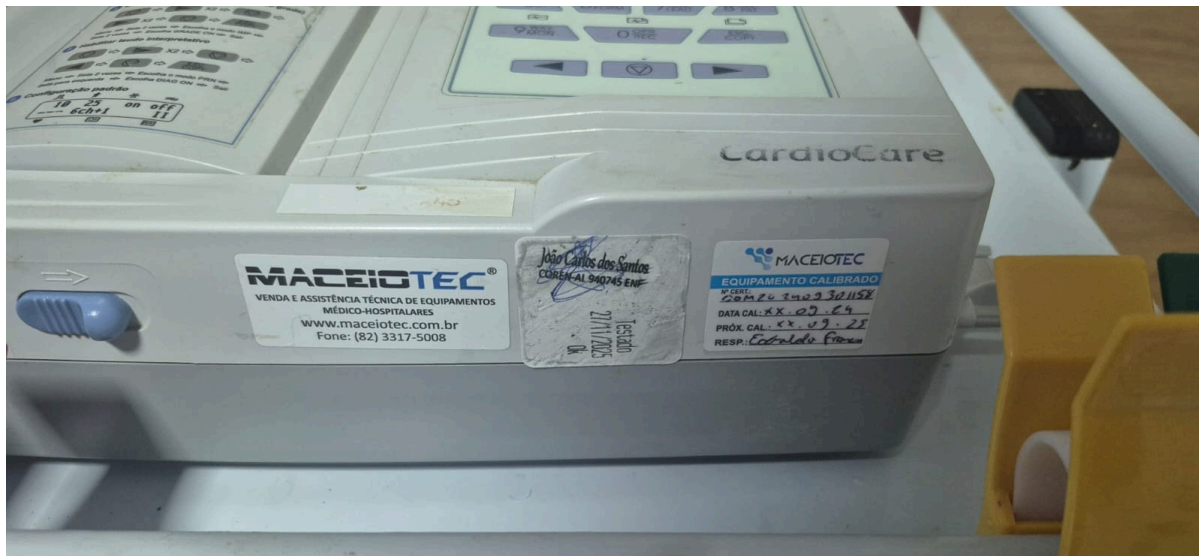
Figura 7 - Etiqueta de Teste e Calibração do Eletrocardiógrafo Fonte: elaboração própria
