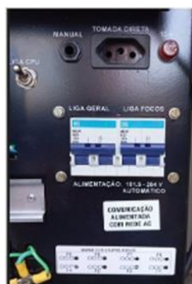
Figura 2.5. Controlador JSM - Tomada auxiliar, disjuntores, chave CPU e aterramento do chassi do controlador.
