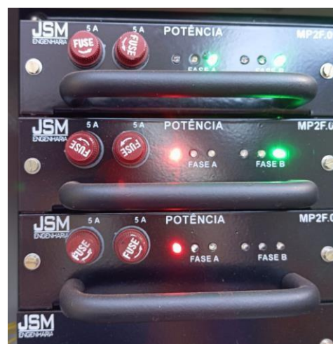
Figura 2.1. Controlador JSM - Módulos de potência.
