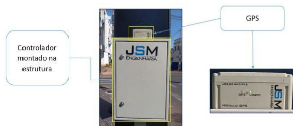
Figura 1. Controlador de semáforo JSM e GPS.
