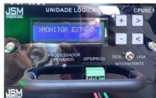
Figura 2.2. Controlador JSM - Unidade lógica CPU.
