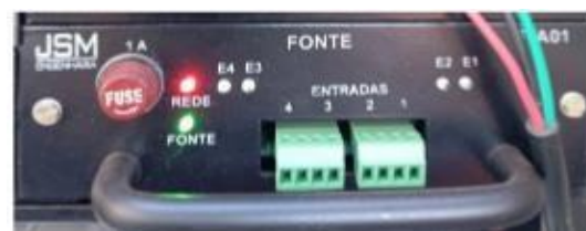
Figura 2.3. Controlador JSM - Fonte de alimentação 12V.
