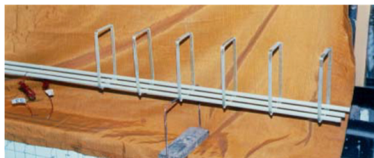
Figura 5. Armaduras utilizadas nas vigas ensaiadas por Duranovic et al. (1997).
