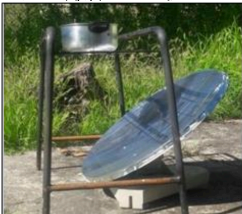
Figura 5. Vista lateral da montagem com recipiente de cozimento (panela) sobre o suporte, posicionado na projeção do foco para a antena.
