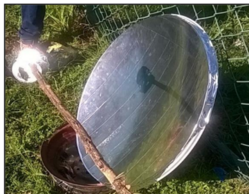
Figura 3. Protótipo parabólico montado com revestimento espelhado com termômetro análogo de forno/estufa no ponto estimado de convergência dos raios solares refletidos.
