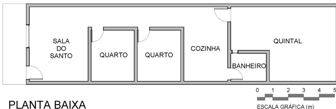
Figura 2: Planta Baixa de uma residência unifamiliar
