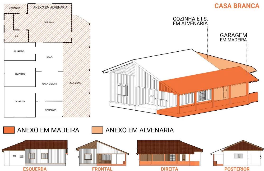
Planta baixa, representação isométrica e vistas da segunda residência inventariada. Fonte: os autores.
