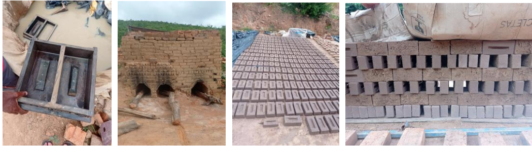
Figura 3: Produção de tijolos em olaria no município de Palmeiras.
