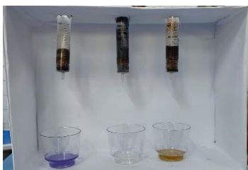
Figura 1. Comparativo dos filtros - Controle, Carvão Ativado e Casca de Abacaxi.
