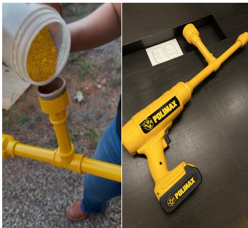
Figura 2. Equipamento para polinização mecânica na cultura do maracujá. Reservatório para armazenamento de pólen (à esquerda) e versão final do equipamento (à direita).
