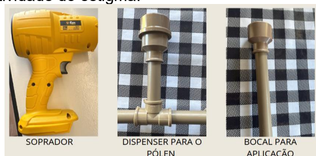
Figura 1: componentes utilizados para a base inicial de construção do polinizador portátil (bocal para aplicação – dispenser para o pólen – soprador). Análise técnica dos componentes utilizados para a base inicial da construção do protótipo do polinizador portátil da cultura do Maracujá.
