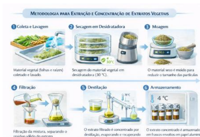
Figura 1- Fluxograma do processo de extração e concentração de extratos vegetais.
