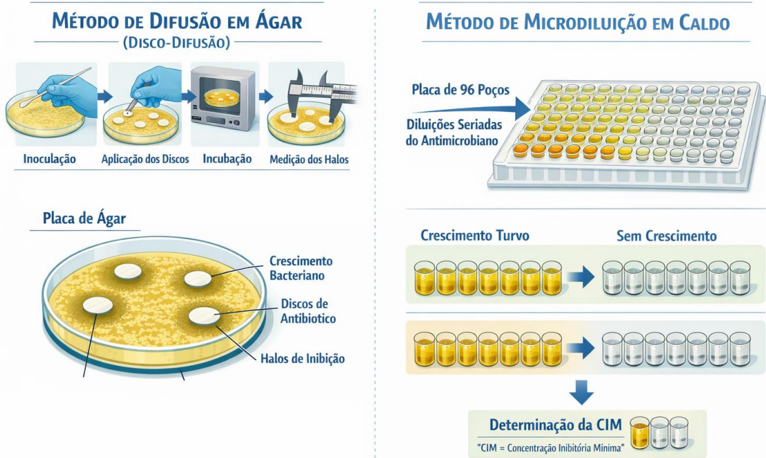
Figura 1 – Comparação entre o método de difusão em ágar (disco-difusão) e o método de microdiluição em caldo para avaliação da atividade antimicrobiana.
