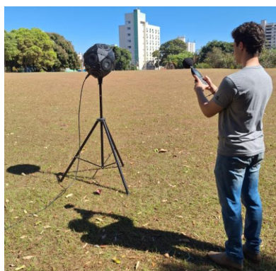
Figura 3: Ensaio em campo livre para avaliação da omnidirecionalidade da fonte sonora.
