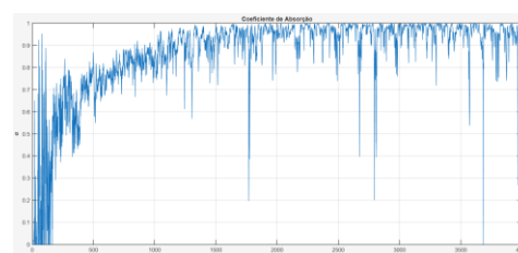
Figura 5: a) Coeficiente de Absorção para amostra de lã de vidro; b) Coeficiente de Absorção para amostra de lã de rocha.
