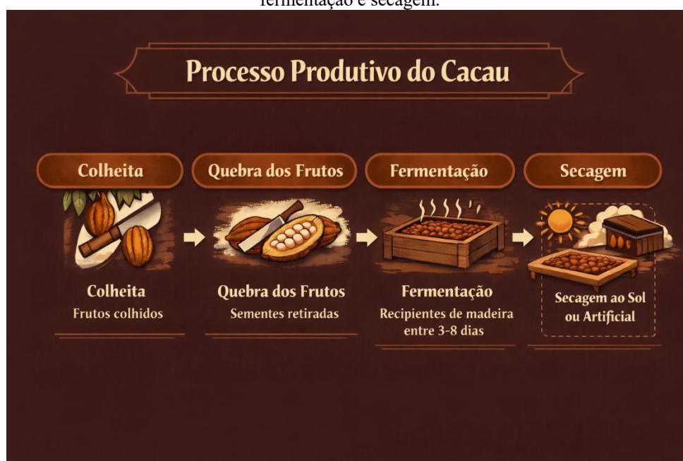
Figura 2 – Fluxograma do processo produtivo do cacau, contemplando as etapas de colheita, quebra dos frutos, fermentação e secagem.
