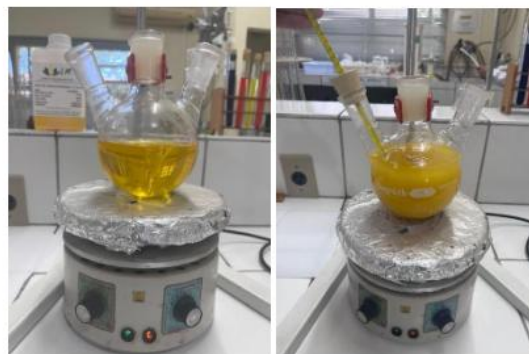
Figura 4: Processo de Transesterificação dos Biodiesel Metílico.
