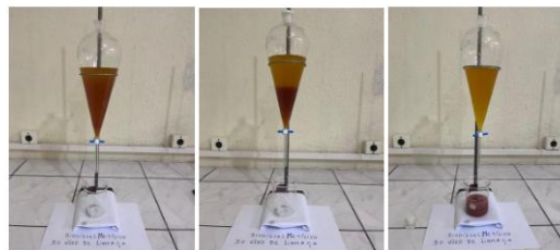
Figura 5: Processo de decantação do biodiesel Metílico do óleo de linhaça.
