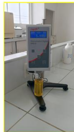
Figura 7: Processo de determinação da viscosidade.
