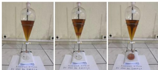
Figura 2: Processo de decantação do biodiesel etílico do óleo de linhaça.
