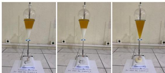
Figura 6: Processo de lavagem do biodiesel Metílico do óleo de linhaça.
