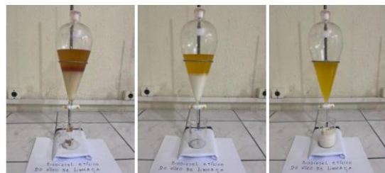
Figura 3: Processo de lavagem do biodiesel etílico do óleo de linhaça.
