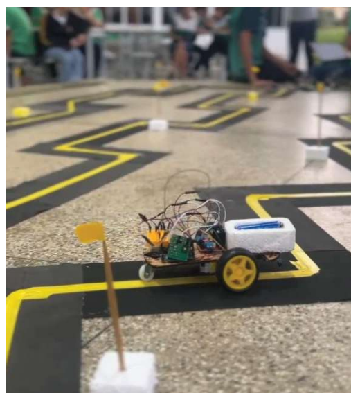
Figure 3: Robô seguidor de linha em momento da Competição de Robótica, na II Semana dos Cursos Técnicos da Área de Informática do IFAM Campus Eirunpé.
