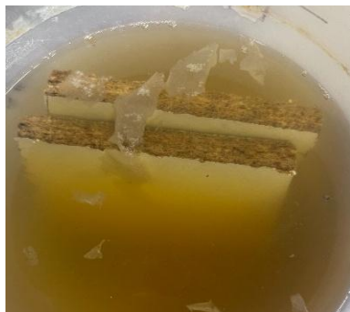
Figura 1. Amostras de MDP submerso em água para simulação da enchente.
