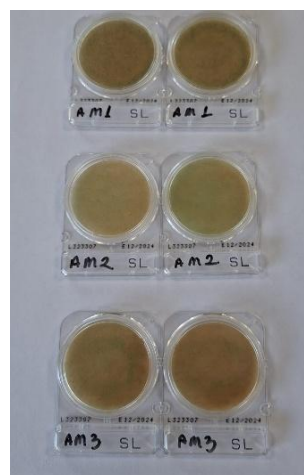
Figura 2. Amostras positivas para Salmonella spp. em mesas de manipulação na sala de abate, analisadas por meio de placas Compact Dry SL® (Nissui Pharmaceutical Co., Ltd.).
