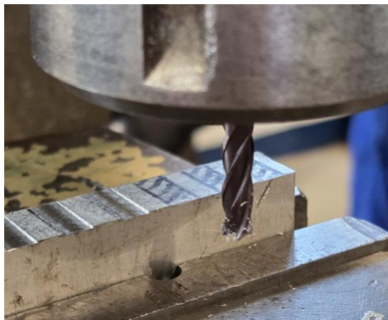
Figura 3: Conjunto de peça, ferramenta e morça utilizados para a usinagem.
