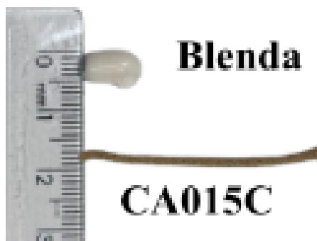
Figura 9. Diferença do inchamento entre a matriz e o compósito.
