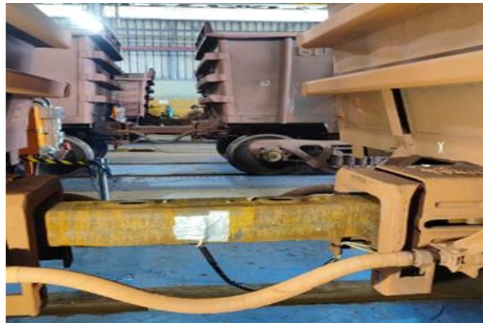
Figura 9. Haste rígida instrumentada instalada na dupla de GDT.
