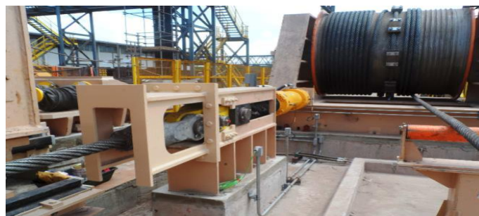
Figura 8. Tambor de acionamento do carro puxador do virador TKS
