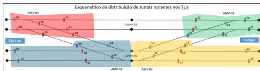
Figura 3. Ensaios Laboratoriais Esquemático de Distribuição de Juntas Isolantes nos TUs (Travessão Universal)
